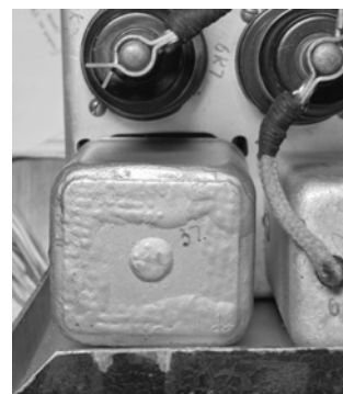
Рис. 7. "УС-П", анодный автотрансформатор (поздний вариант конструкции)
